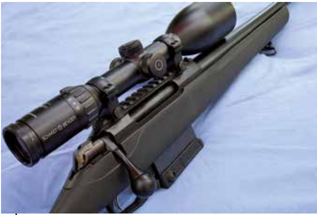
Die Tikka T3x CTR mit dem S&B 2,5-10x56, hinter dem Kammerstengel: die zusätzliche ASH-Sicherung
