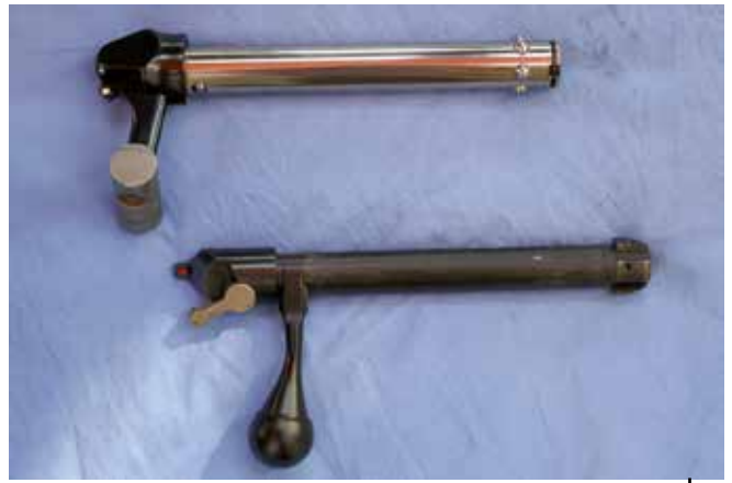
Die Verschlüsse im Vergleich, unten Tikka mit zwei Verriegelungswarzen, oben Heym mit den 6 Verriegelungskugeln
